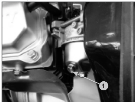
Рис. 18 Слив топлива из карбюратора 1. Болт сливной
