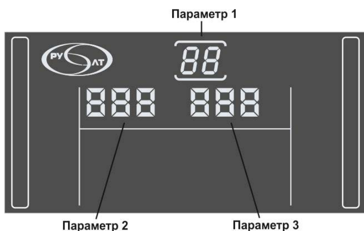
Рисунок 4. Меню настройки ИБП.
