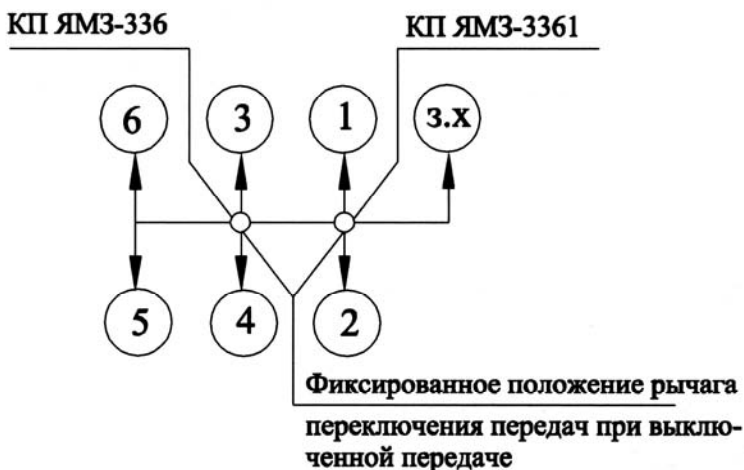
Рис. 111. Схема переключения передач КПП.
