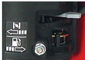
Рис. 4.8: Закрывать топливный кран
