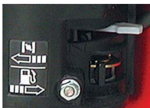
Рис 4.6: Выключение топливного крана
